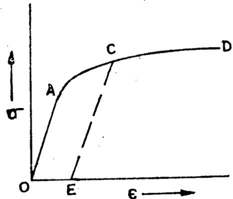
FIG. 4. STRESS-STRAIN CURVE
