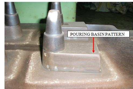
Fig. 1(c). Pouring basin
